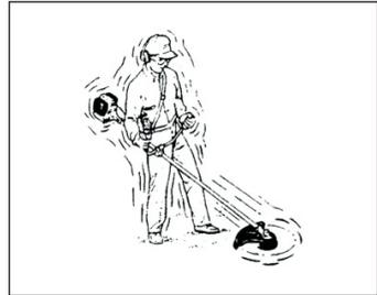
Desligue o motor imediatamente caso ocorra a vibração repentina do equipamento.
