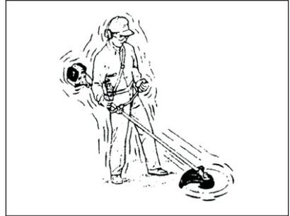
Caso a lâmina prenda na madeira ou capim, não tente livrá-la acelerando o motor ou mexendo o equipamento, uma vez que forçará o equipamento e entortará a lâmina. Caso isto ocorra, desligue o motor e manualmente (com luvas de proteção) solte a lâmina de corte.
